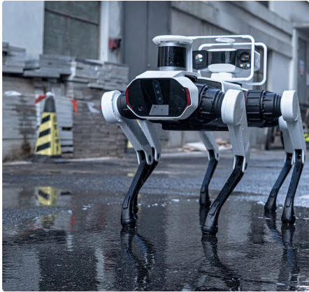
机器狗在操控终端控制下 在放射性环境中巡检
